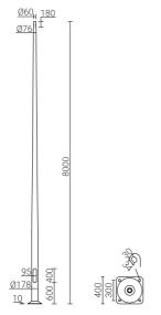
Анодирование: 10 цветов, каждый с возможностью глянца Материал: шлифованный, анодированный алюминий, с дополнительной возможностью обеспечения эластомером по цвету опоры до высоты 350 мм (другая высота по желанию клиента)
